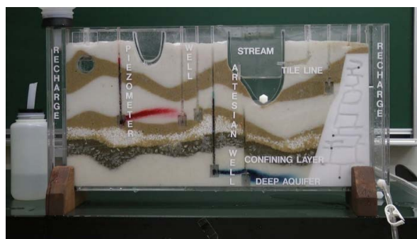
Fig. 4 Groundwater Flow Model を用いた実験様子
